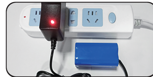
Rozhraní nabíjení akumulátoru Připojte akumulátor k nabíječce. Červené světlo: Nabíjení Zelené světlo: Nabíjení dokončeno
