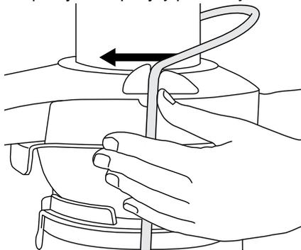
6. Wsuń popychacz do otworu wyspowego – wgłębienie na popychaczu należy wyrównać z niewielkim występnym wewnątrz otworu wyspowego.
