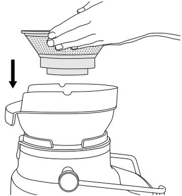
3. Na držák síta nasad'te kryt tak, aby byl plnicí otvor umístěn nad nerezovým sítem.
