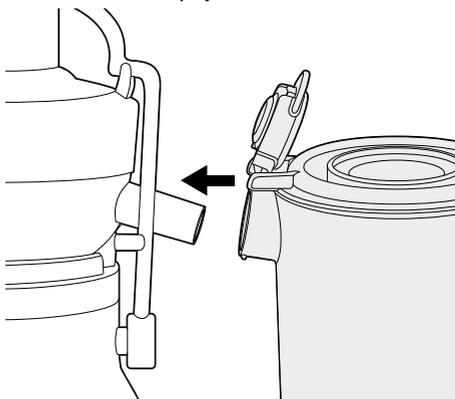
10. Opcjonalne: Aby móc wyciskać sok bezpośrednio do szklanki, załóż na podajnik soku dozownik.
