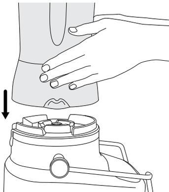
2. Rameno s bezpečnostním zámkem nasad'te do drážek umístěných po obou stranách krytu.
