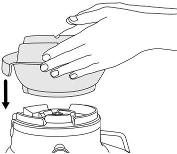
2. Zarovnejte šípky na spodní části nerezového síta se šípkami na hřídeli motoru a přitlačte síto na hřídel, až uslyšíte cvaknutí, abyste bezpečně zajistili nerezové síto na motorovou základnu.
