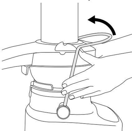
5. A karnak most függőleges helyzetben kell lennie, rögzítve a fedélen.
