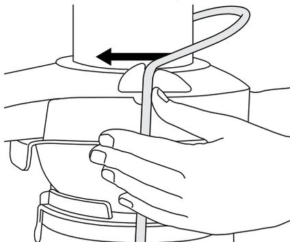
6. Zatláčadlo vsuňte do plniaceho otvoru – drážku na zatláčadle musíte zarovnať s malým výstupkom na vnútornej strane plniaceho otvoru.
