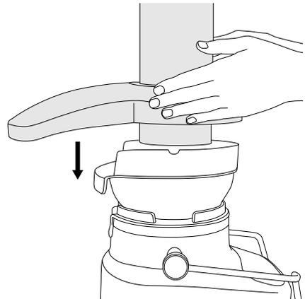
4. Rameno s bezpečnostním zámkem nasadíte do drážek umístěných po obou stranách krytu.
