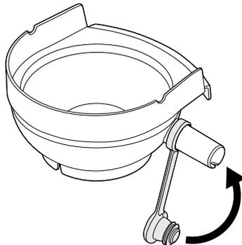
9. Nasad'te veko na nádobu na šťavu/mixovanie, umiestnite ju tak, aby bol vývod šťavy umiestnený v otvore v nádobe.
