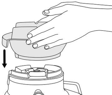
2. Wyrównaj strzałki w dolnej części nierdzewnego sitka ze strzałkami na wale silnika i dociśnij sitko do wału, aż usłyszysz kliknięcie, aby bezpiecznie zablokować sitko nierdzewne na korpusie silnika.
