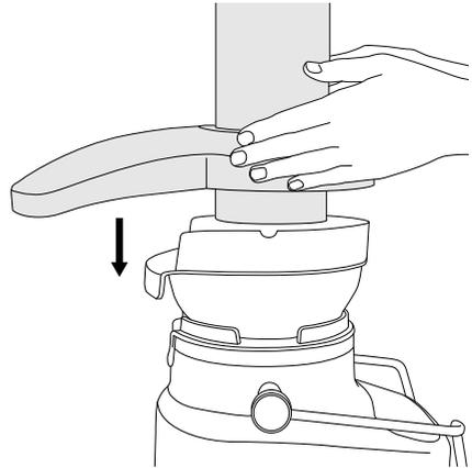
4. Rameno s bezpečnostným zámkom nasadte do drážok umiestnených po oboch stranách krytu.
