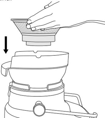
3. Na držiak sita nasadte kryt tak, aby bol plniaci otvor umiestnený nad antikorovým sitom.
