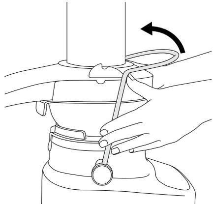
5. Rameno by teraz malo byť vo vertikálnej polohe a zaistené na kryte.
