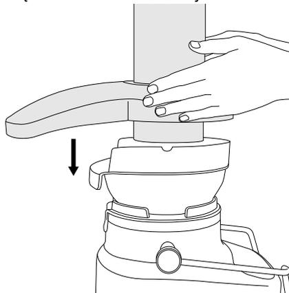
4. Ramię z blokadą bezpieczeństwa włóż do wgłębień umieszczonych po obu stronach pokrywki.
